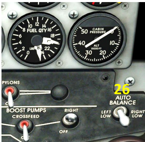
26. Stelle den AUTO BALANC Schalter auf LEFT LOW
